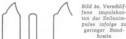
Bild 3a. Verschlif-fene Impulskanten der Zeilenimpulse infolge zu geringer Bandbreite
