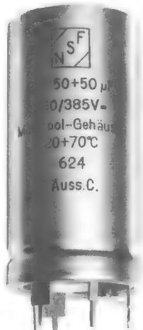
Steckausführung für gedruckte Schaltung (DIN 41 318)
