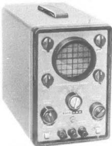
Klein-Oszillograph mit 7,5 cm Planschirmröhre, Rücklaufaustastung, Helligkeitsmodulationsanschluß (2 MOhm/25 pF), Astigmatismusregler, Mu-geschirmter Hals, 1500 V Beschleunigungsspannung, stabilisiertes Netzteil, Direktanschlußmöglichkeit der Vertikalplatten, besonders kleine Ausführung, Größe: 21,6x14,6x28,6 cm, Gewicht: ca. 5 kg
