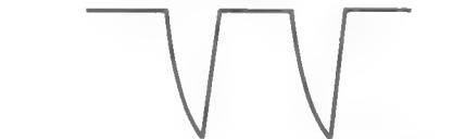
Bild 6. Form der Zeilen-Austastimpulse an der Bildröhre
