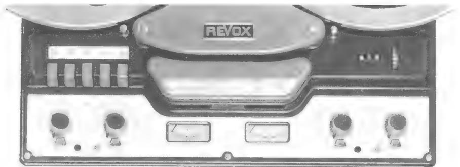
Bild 2. Anordnung der beiden VU-Meter für die Stereo-Aussteuerung
